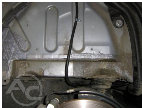
Рис. 1.3.6 Крепление шланга заправки
