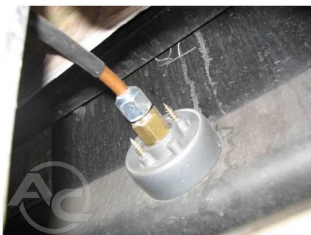
Рис. 1.3.3 Внешний вид заправочного клапана с внутренней стороны
