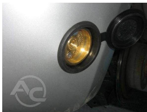
Рис. 1.3.4 Внешний вид заправочного клапана с внешней стороны
