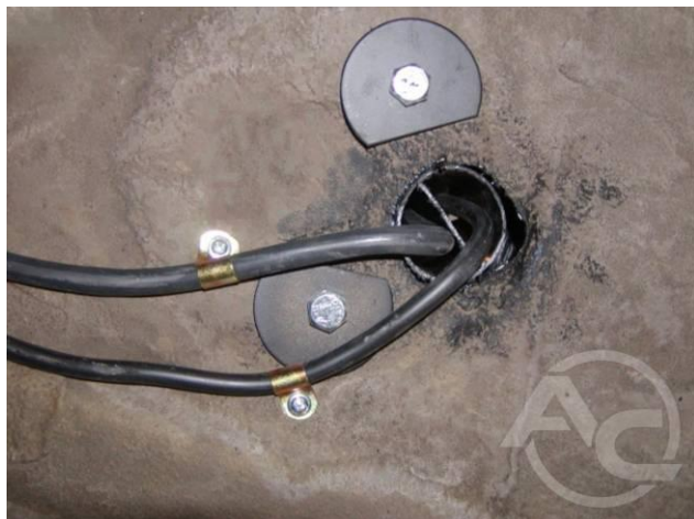
Рис. 1.3.20 Прохождение газоподводов через шасси
