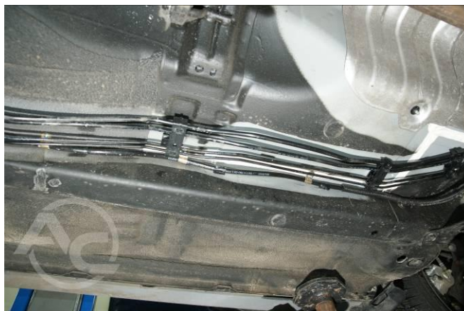
Рис. 1.3.24 Мокowanie за pomocą opasek metalowych
