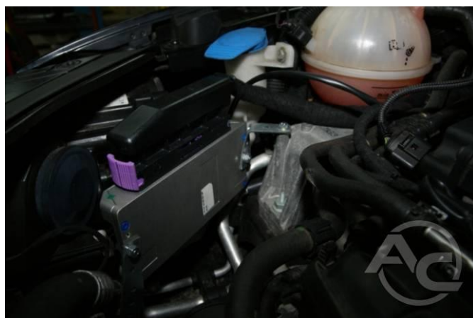
Рис. 1.3.31 Внешний вид установленного контроллера
