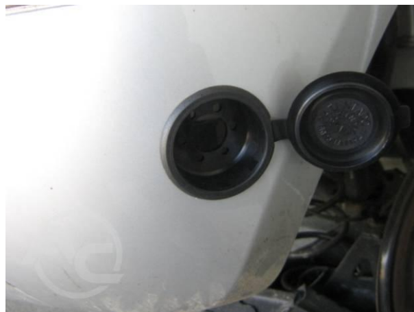
Рис. 1.3.2 Монтаж крышки заправочного клапана
