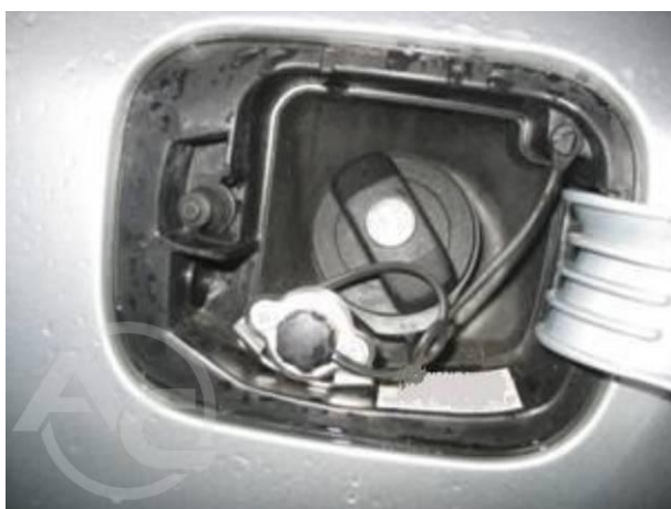
Рис. 1.3.5 Заправочный клапан в углублении заливного отверстия бензина
