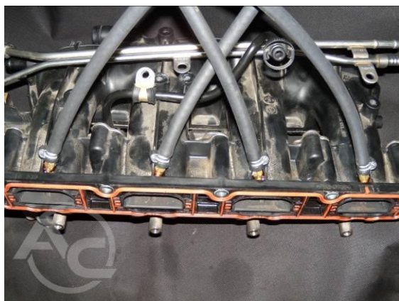
Рис. 1.3.33 Место монтажа сопел в коллекторе (вид снаружи)
