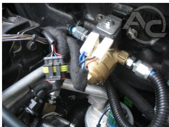
Рис. 1.3.23 Соединение проводки с электроклапаном.
